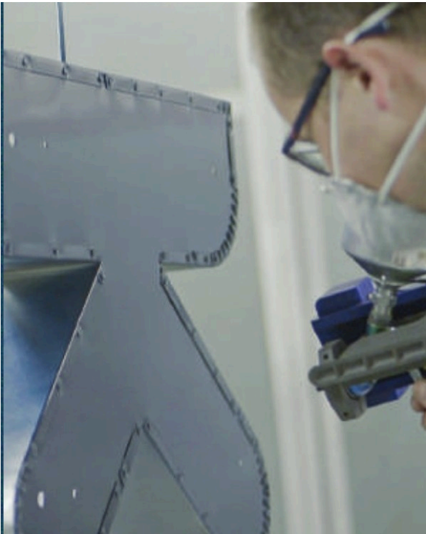
Capteur de mouvement fixé sur le pistolet : le peintre encode la première pièce, le robot peint les suivantes.
